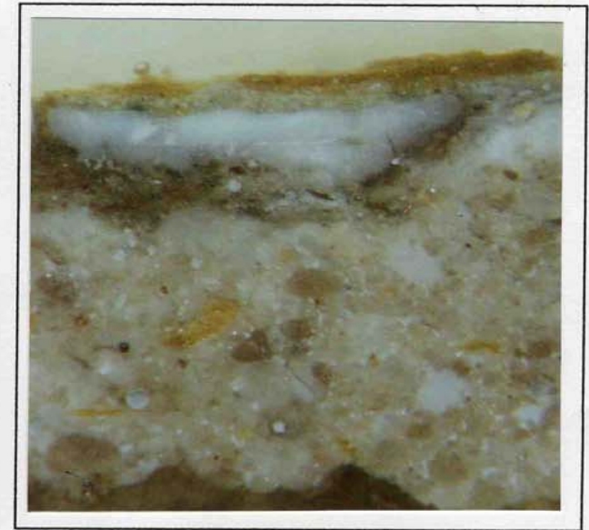
sezione stratigrafica (25X) intonaco originale, con sovrapposta la finitura a marmorino e due ridi- pinture a base di ocre stemperate in acqua di calce.
